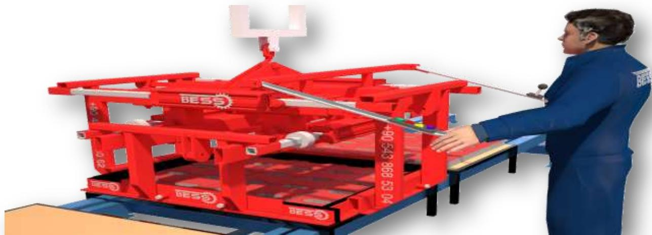
СИСТЕМА ЛИФТА КОТОРАЯ РАЗБИРАЕТ ПО ОДНОМУ ПОДДОНУ КОТОРЫЕ ПОГРУЗЧИК ПРИВЕЗ ИЗ КОМНАТЫ СУШКИ И ПОДАЕТ ИХ АВТОМАТИЧЕСКОМУ РОБОТУ ДЛЯ СБОРКИ. ДВИЖЕТСЯ БЛАГОДАРЯ ПНЕВМАТИЧЕСКУЮ СИСТЕМУ. ВО ВРЕМЯ ПРОЦЕССА СБОРКИ ИЗДЕЛИЙ, РУЧНОЙ РОБОТ УМЕЕТ СДЕЛАТЬ ВСЮ РАБОТУ БЫСТРО И В ОДНОЙ ТОЧКЕ. БЛАГОДАРЯ ДВИГАТЕЛЮ И ПОДВЕСКЕ НА НЕМ, УСПЕВАЕТ ДЕЛАТЬ ВПРАВО-ВЛЕВО И ВВЕРХ И ВНИЗ. МОЩНОСТЬ ДВИГАТЕЛЯ 0,2 кВт.
