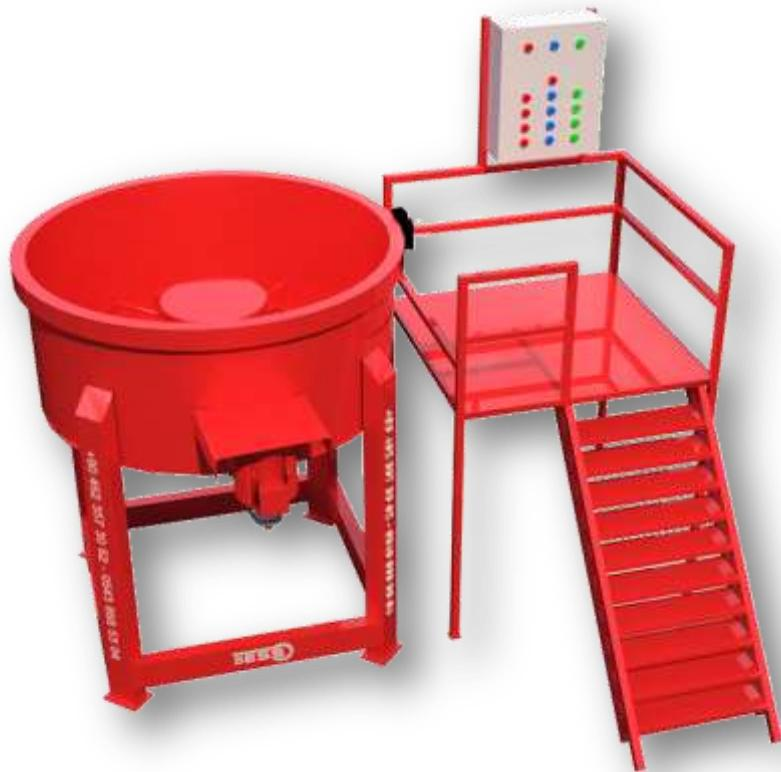
ПЛАТФОРМА ОПЕРАТОРА (СМЕСИТЕЛЬ) ЭТО МЕСТО ГДЕ ЯВЛЯЕТСЯ ЧЕЛОВЕКОМ СМОТРЕТЬ ПРОЦЕСС СМЕШИВАНИЯ СТРОИТЕЛЬНОГО РАСТРОВА И МЕСТО ГДЕ ДАЮТ КОМАНДЫ.) РАСТВОР ЭЛЕКТРИЧЕСКАЯ ПАНЕЛЬ ВЫПОЛНЕНА В СООТВЕТСТВИИ С ПОРЯДКОМ РАБОТЫ, ПРИ КОТОРОМ ОПЕРАТОР БУДЕТ ТЯНУТЬ НУЖНЫЙ МАТЕРИАЛ ДЛЯ СМЕСИ. С ПОМОЩЬЮ ЭТОЙ ФУНКЦИИ ДАЖЕ НА РУЧНОМ УПРАВЛЕНИИ МОЖНО ЛЕГКО ИСПОЛЬЗОВАТЬ.
