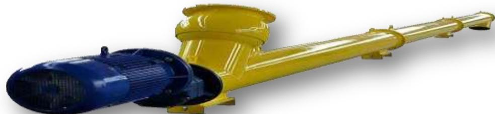
ОБЕСПЕЧИВАЕТ ПЕРЕДАЧУ ЦЕМЕНТА ИСПОЛЬЗУЕМОГО В РАСТВОРЕ ИЗ СИЛОСА В СИСТЕМУ ВЗВЕШИВАНИЯ. МАРКА WAM 8' (Ø219 мм) МОЩНОСТЬ ДВИГАТЕЛЯ 9.2 кВт. РАСПОЛОЖЕНИЕ СИЛОСА СОЕДИНЕНИЕ ПОДВИЖНОЕ. СМОЖЕТ ДВИГАТЬСЯ В НУЖНОЕ МЕСТО.
