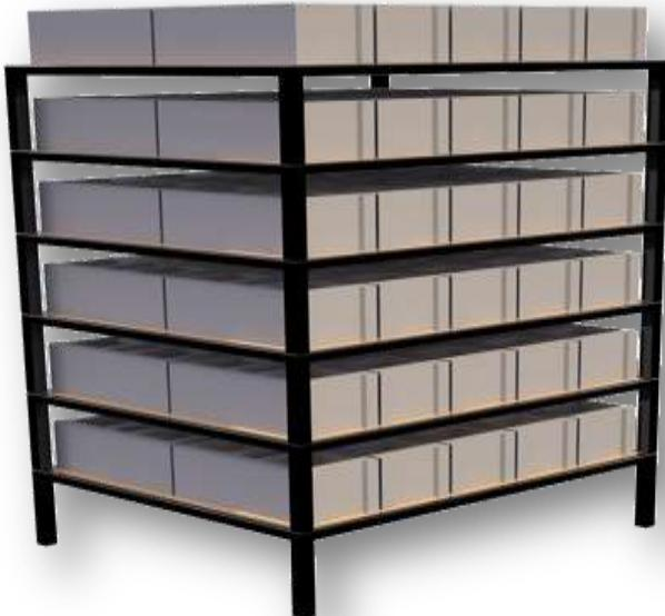
ПРОИЗВОДСТВЕННЫЙ ПОДДОН НА КОТОРЫЙ МАШИНА ПРЕССУЕТ ИЗДЕЛИЯ. РАЗМЕР ПОДДОНА 85 см. x 95 см. x 4 см. ИЗДЕЛИЯ ОСТАЮТСЯ НА ПОДДОНЕ ПОКА ПОЛНОСТЬЮ НЕ ВЫСОХНУТ, ПОТОМ ПО ОЧЕРЕДИ КАКИЙ ПОДДОН С ПОМОЩЬЮ РОБОТА ПУСТЫХ ПОДДОНОВ ИДЕТ ПО
