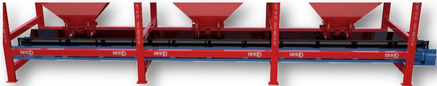
ЛЕНТОЧНЫЙ КОНВЕЙЕР ВЗВЕШИВАЯ МАТЕРИАЛЫ, ПЕРЕДАЕТ ИЗ БУНКЕРА, НА ЛЕНТУ ПЕРЕДАЧИ ИНЕРТНЫХ МАТЕРИАЛОВ. ЛЕНТА РАСПОЛОЖЕНА ПОД БУНКЕРОМ. ШАССИ КОНВЕЙЕРНОЙ ЛЕНТЫ ИЗГОТОВЛЕНА ПО КАЧЕСТВУ ISO9001 СООТВЕТСТВУЕТ НОРМАМ DIN. ПРОФИЛЬ ТОЛЩИНОЙ 40Х80Х3мм.КОРПУС 3 мм.ПОСТАВЛЕНЫ В ПРОМЕЖУТКАХ 90 см.РЕЗИНЫ ТОЛЩИНОЙ 8 мм.РОЛИКИ 3"(Ø 89 мм). ЭЛЕКТРОННЫЙ КОНВЕЙЕР ПРИВОДИТСЯ В ДВИЖЕНИЕ ДВИГАТЕЛЕМ И РЕДУКТОРАМИ.МОЩНОСТЬ ДВИГАТЕЛЯ 2,2 кВт
