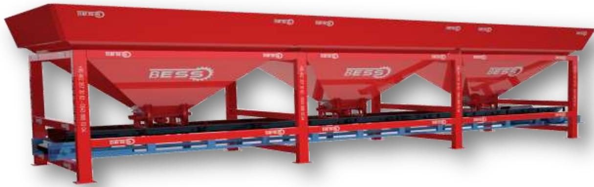
НАКОПИТЕЛЬ В КОТОРОМ ХРАНИТСЯ ИНЕРТНЫЙ МАТЕРИАЛ ИСПОЛЬЗУЕМЫЙ В СМЕСЕ СЫРЬЯ: ПЕСОК, ЩЕБЕНЬ, ГРАВИЙ И Т.Д ПОД КАЖДЫМ РЕЗЕРВУАРОМ БУНКЕРА ИМЕЕТСЯ ДВЕ КРЫШКИ. **ШАССИ:** ШАССИ БУНКЕРА ИЗГОТОВЛЕНА ПО КАЧЕСТВУ ISO9001 СООТВЕТСТВУЕТ НОРМАМ DIN. ПРОФИЛЬ ИЗ ЖЕСТИ ТОЛЩИНОЙ 150Х100Х6мм.КАЖДАЯ КРЫШКА КОНТРОЛИРУЕТСЯ С ПОМОЩЬЮ СОБСТВЕННОГО ПНЕВМАТИЧЕСКОГО КЛАПАНА.
