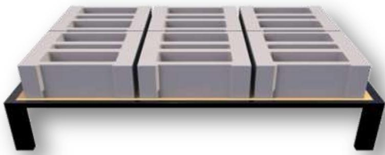
ИСПОЛЬЗОВАТЬ ПОДДОНАМИ В ПРОИЗВОДСТВЕ. ПРИ ИЗГОТОВЛЕНИИ ПОДДОНА ИСПОЛЬЗУЕТСЯ ПЕРВОКЛАССНАЯ ДРЕВЕСИНА БЕЗ СУЧКОВ. ВЕРХНЯЯ И НИЖНЯЯ ПОВЕРХНОСТЬ ШЛИФУЕТСЯ, ВЛАЖНОСТЬ ДРЕВЕСИНЫ СНИЖАЕТСЯ ДО 20 % ДОСТКИ ЗАКРЕПЛЯЮТСЯ ДРУГ К ДРУГУ - МЕЖДУ НИМИ МАЖЕТСЯ МОРСКОЙ КЛЕЙ. РАМА ИЗ СТАЛЬНОЙ ЖЕСТИ ШИРИНОЙ 4 см. МИНИМАЛЬНАЯ ТОЛЩИНА 4 мм. КАЧЕСТВО ЖЕСТИ ST-52 A-1.
