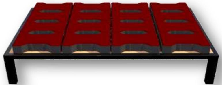
ВЕРХНЯЯ И НИЖНЯЯ ПОВЕРХНОСТЬ ШЛИФУЕТСЯ, ВЛАЖНОСТЬ ДРЕВЕСИНЫ СНИЖАЕТСЯ ДО 20 % ДОСТКИ ЗАКРЕПЛЯЮТСЯ ДРУГ К ДРУГУ - МЕЖДУ НИМИ МАЖЕТСЯ МОРСКОЙ КЛЕЙ. РАМА ИЗ СТАЛЬНОЙ ЖЕСТИ ШИРИНОЙ 4 см. МИНИМАЛЬНАЯ ТОЛЩИНА 4 мм. КАЧЕСТВО ЖЕСТИ ST-52 A-1.
