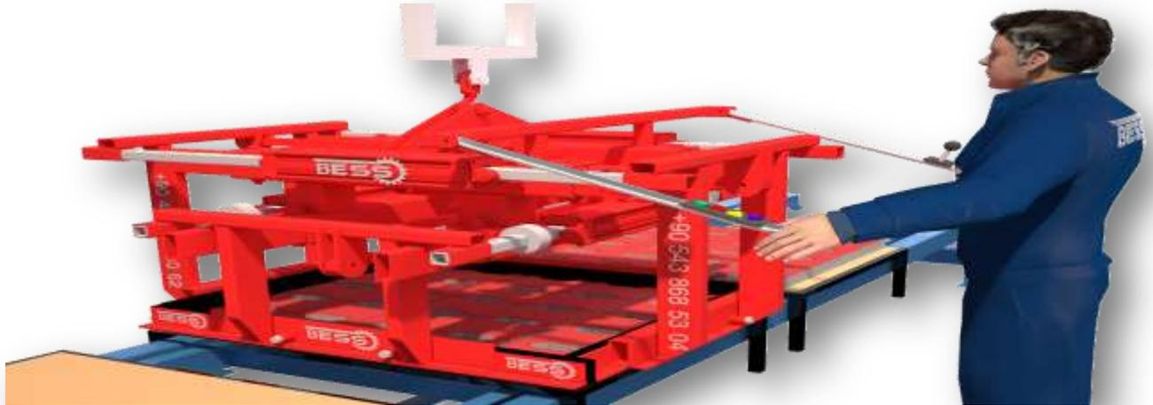
СИСТЕМА ЛИФТА КОТОРАЯ РАЗБИРАЕТ ПО ОДНОМУ ПОДДОНУ КОТОРЫЕ ПОГРУЗЧИК ПРИВЕЗ ИЗ КОМНАТЫ СУШКИ И ПОДАЕТ ИХ АВТОМАТИЧЕСКОМУ РОБОТУ ДЛЯ СБОРКИ. ДВИЖЕТСЯ БЛАГОДАРЯ ПНЕВМАТИЧЕСКУЮ СИСТЕМУ. ВО ВРЕМЯ ПРОЦЕССА СБОРКИ ИЗДЕЛИЙ, РУЧНОЙ РОБОТ УМЕЕТ СДЕЛАТЬ ВСЮ РАБОТУ БЫСТРО И В ОДНОЙ ТОЧКЕ. БЛАГОДАРЯ ДВИГАТЕЛЮ И ПОДВЕСКЕ НА НЕМ, УСПЕВАЕТ ДЕЛАТЬ ВПРАВО-ВЛЕВО И ВВЕРХ И ВНИЗ. МОЩНОСТЬ ДВИГАТЕЛЯ 0,2 кВт.
