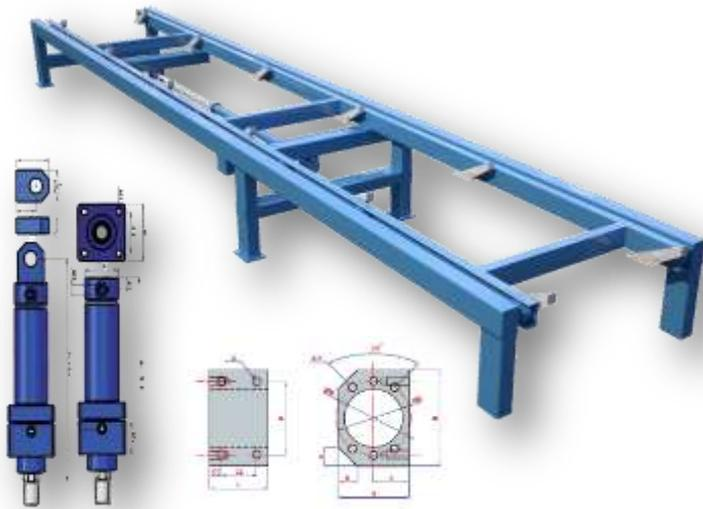
СТЕЛЛАЖ КОТОРЫЙ ПЕРЕПРАВЛЯЕТ ПОДДОНЫ ВЫШЕДШИЕ ИЗ РОБОТА ПУСТЫХ ПОДДОНОВ И К МАШИНЕ. СО СВОИМИ ЗУБАМИ ПОДДОНЫ НА ИЗДЕЛИИ, СОБИРАЮТСЯ БЛАГОДАРЯ РУЧНОГО РОБОТА (УКЛАДЧИК). С ПОМОЩЬЮ ПЕРЕКЛЮЧАТЕЛЯ ПОЛУЧАЕТ КОМАНДЫ ВПЕРЕД-НАЗАД. НА ГЛАВНОМ ШАССИ ИСПОЛЬЗОВАЛИ КОРОБЧАТЫЙ ПРОФИЛЬ 40x120x6мм. ЗУБЫ ИЗГОТОВЛЕННЫ ИЗ СПЕЦИАЛЬНОГО СТАЛЬНОГО МАТЕРИАЛА.
