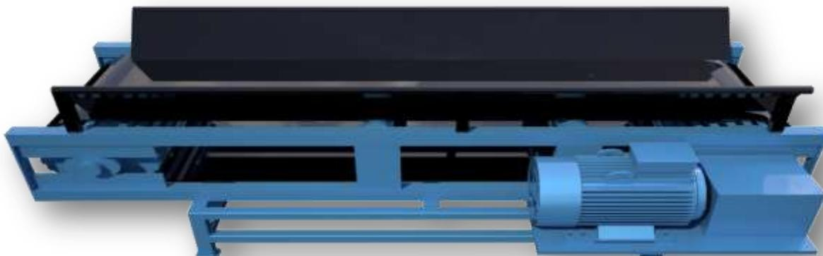
ЭТО АППАРАТ КОТОРЫЙ ОБЕСПЕЧИВАЕТ ПЕРЕДАЧУ ТОНКИЙ РАСТВОРА В ТОНКИЙ ИНЕРТНЫЙ БУНКЕР, ОТПРАВЛЯЕТ ТОЛЩИНОЙ РАСТВОРА В ТОЛЩИНОЙ ИНЕРТНЫЙ БУНКЕР.МИНИ КОНВЕЙЕР РАЗРАБОТАН ТАКИМ ОБРАЗОМ ЧТО ДВИГАЕТСЯ НАПРАВО-НАЛЕВО.МОЩНОСТЬ ДВИГАТЕЛЯ:2.2 кВт.С ПОМОЩЬЮ КНОПКИ ДАЕТ КОМАНДЫ НА ЭЛЕКТРИЧЕСКОЙ ПАНЕЛИ В ПЕРЕДНЕЙ ЧАСТИ ОПЕРАТОРА СМЕСИТЕЛЯ.
