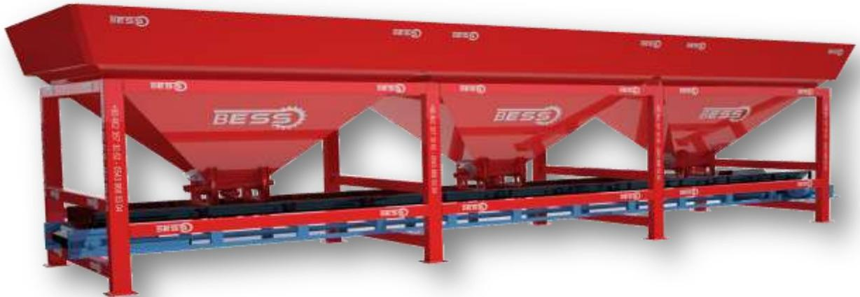
НАКОПИТЕЛЬ В КОТОРОМ ХРАНИТСЯ ИНЕРТНЫЙ МАТЕРИАЛ ИСПОЛЬЗУЕМЫЙ В СМЕСЕ СЫРЬЯ: ПЕСОК, ЩЕБЕНЬ, ГРАВИЙ И Т.Д ПОД КАЖДЫМ РЕЗЕРВУАРОМ БУНКЕРА ИМЕЕТСЯ ДВЕ КРЫШКИ. **ШАССИ:** ШАССИ БУНКЕРА ИЗГОТОВЛЕНА ПО КАЧЕСТВУ ISO9001 СООТВЕТСТВУЕТ НОРМАМ DIN. ПРОФИЛЬ ИЗ ЖЕСТИ ТОЛЩИНОЙ 150X100X6ММ.КАЖДАЯ КРЫШКА КОНТРОЛИРУЕТСЯ С ПОМОЩЬЮ СОБСТВЕННОГО ПНЕВМАТИЧЕСКОГО КЛАПАНА.
