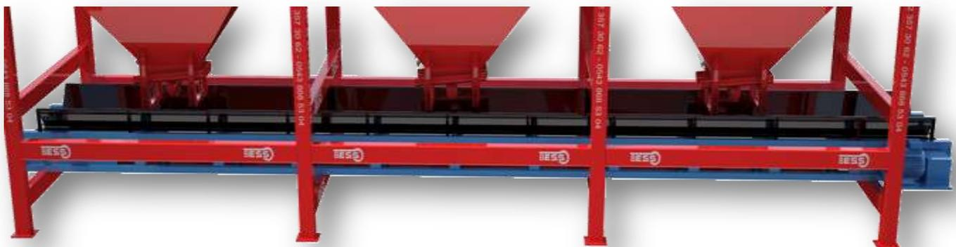
ЛЕНТОЧНЫЙ КОНВЕЙЕР ВЗВЕШИВАЯ МАТЕРИАЛЫ, ПЕРЕДАЕТ ИЗ БУНКЕРА, НА ЛЕНТУ ПЕРЕДАЧИ ИНЕРТНЫХ МАТЕРИАЛОВ. ЛЕНТА РАСПОЛОЖЕНА ПОД БУНКЕРОМ. ШАССИ КОНВЕЙЕРНОЙ ЛЕНТЫ ИЗГОТОВЛЕНА ПО КАЧЕСТВУ ISO9001 СООТВЕТСТВУЕТ НОРМАМ DIN. ПРОФИЛЬ ТОЛЩИНОЙ 40X80X3ММ.КОРПУС 3 ММ.ПОСТАВЛЕНЫ В ПРОМЕЖУТКАХ 90 СМ. РЕЗИНЫ ТОЛЩИНОЙ 8 ММ.РОЛИКИ 3"(Ø 89 ММ). ЭЛЕКТРОННЫЙ КОНВЕЙЕР ПРИВОДИТСЯ В ДВИЖЕНИЕ ДВИГАТЕЛЕМ И РЕДУКТОРАМИ.МОЩНОСТЬ ДВИГАТЕЛЯ 2,2 кВт.
