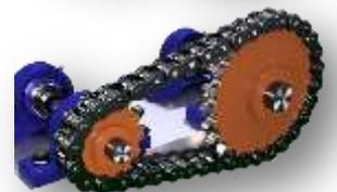
ЭТО ОБОРУДОВАНИЕ ОТПРАВЛЯЕТ ПРЕССОВАНИЕ ИЗДЕЛИЙ КОТОРЫЕ БЫВАЮТ НА ПОДДОНЫ К РОБОТУ (НАКОПИТЕЛЬ) ПРИВОДИТСЯ В ДВИЖЕНИЕ ДВИГАТЕЛЬ С РЕДУКТОРОМ И С ЦЕПНЫМ РЕДУКТОРОМ. ПОЛУЧЕННОЙ ОТ ПЕРЕКЛЮЧАТЕЛЯ В СООТВЕТСВИИ С КОМАНДОЙ ЕСТЬ ФУНКЦИЯ СИСТЕМЫ СТАРТ СТОП.МОЩНОСТЬ ДВИГАТЕЛЯ 2.2 кВт.
