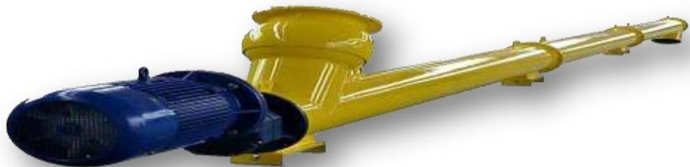
ОБЕСПЕЧИВАЕТ ПЕРЕДАЧУ ЦЕМЕНТА ИСПОЛЬЗУЕМОГО В РАСТВОРЕ ИЗ СИЛОСА В СИСТЕМУ ВЗВЕШИВАНИЯ. МАРКА WAM 8' (Ø219 мм) МОЩНОСТЬ ДВИГАТЕЛЯ 9.2 кВт. РАСПОЛОЖЕНИЕ СИЛОСА СОЕДИНЕНИЕ ПОДВИЖНОЕ. СМОЖЕТ ДВИГАТЬСЯ В НУЖНОЕ МЕСТО.
